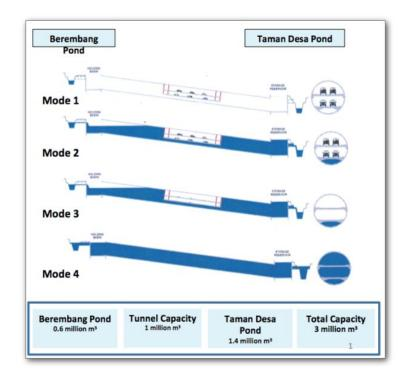
FIGURE 47: APPENDIX D PHASES OF OPERATION FOR SMART TUNNEL, MALAYSIA
